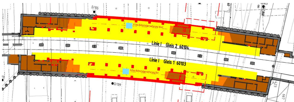
Abb. 30 Stadtbahnanlage Dortmund Hbf: Maßnahme Bahnsteigverbreiterung
