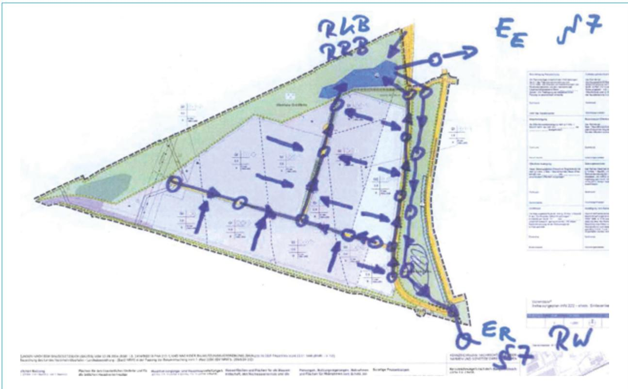
Abbildung 18: Bebauungsplan InN 222 – ehemalige Sinteranlage – Entwässerungsskizze
