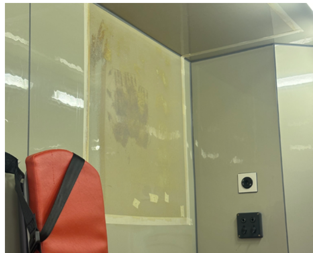
Nachweis einer Oberflächenkontamination im RTW
