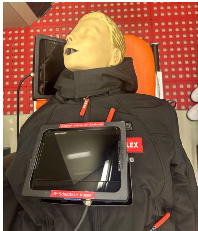
Versuchsaufbau zum Nachweis von Oberflächenkontaminationen durch Atemaerosole
