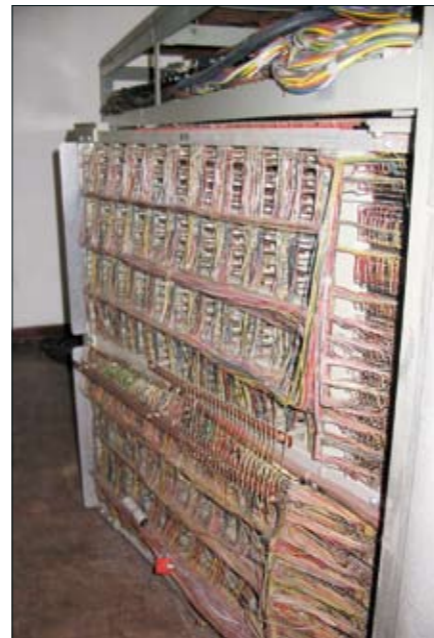
Zuse-Relais-Rechner Z 11 : Steuerungsfeld / Blick auf ein Relaisfach / Ensemble aus Drucker (Schreibmaschine), Rechnersteuerung und Eingabefeld (Lochstreifenleser)
