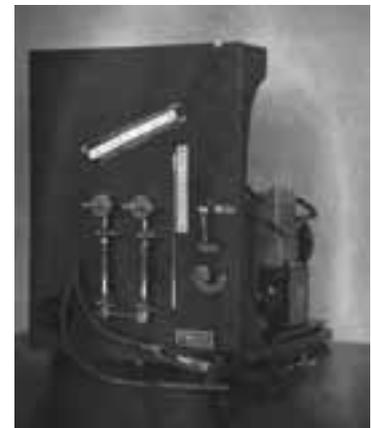
Gerät zur Messung der Staubfiltereigenschaften der Nase
